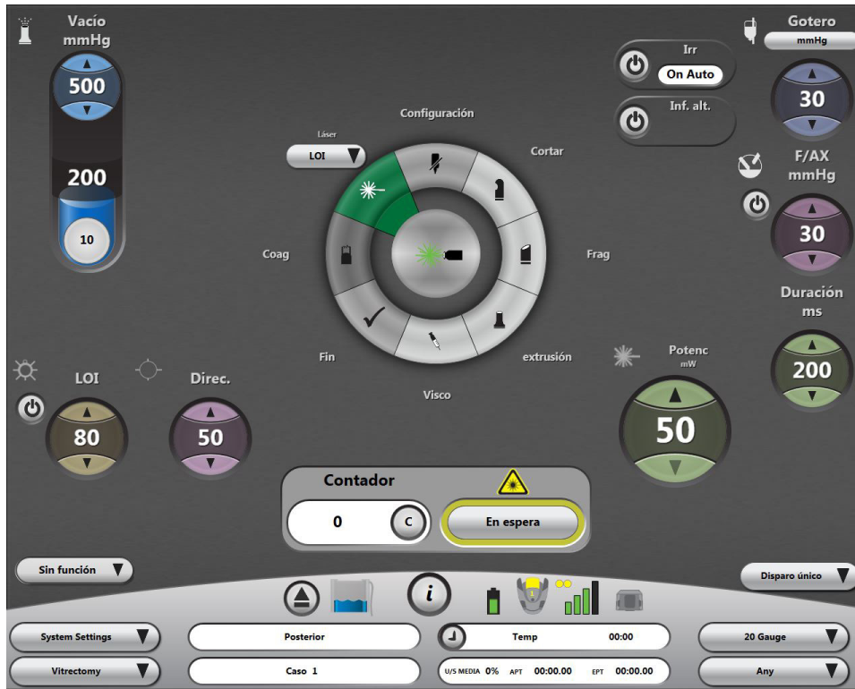
Figura 1.56. Pantalla quirúrgica, submodo de láser “LIO”, láser en modo “En espera”.
