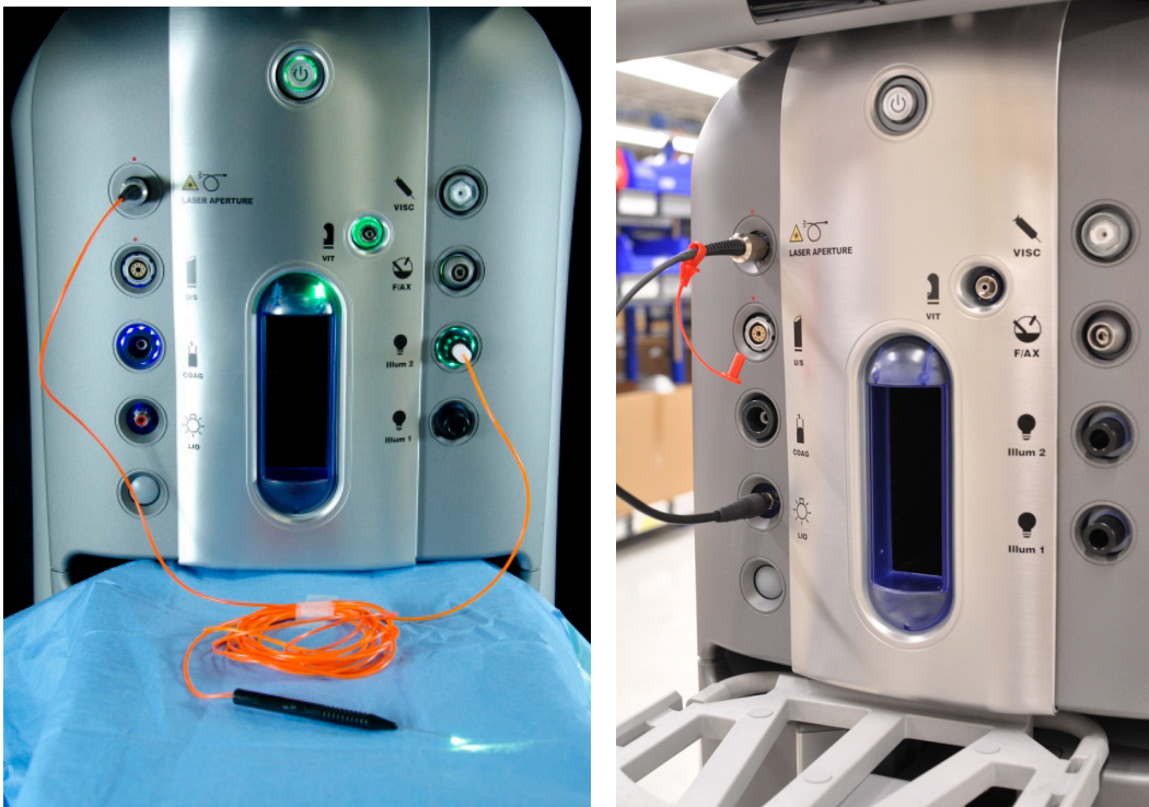
Figura 1.51. Mango de láser (izquierda) y LOI (derecha) conectado al sistema.
