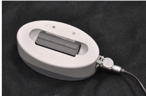
Figura 1.36. Base de conexión para el cargador del pedal de control.
