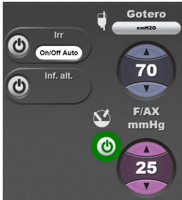
Figura 4.14. Un anillo verde en el interruptor de encendido/apagado indica que la bomba de aire se ha encendido.
