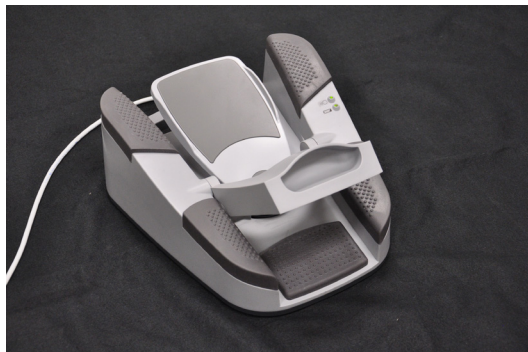
Figura 1.52. Pedal de control principal (integrado), con interruptor de disparo de láser protegido por una cubierta de seguridad (abierta).
