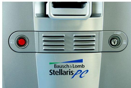
Figura 1.50. Panel frontal con botón de parada de emergencia del láser, respiraderos e interruptor de llave.
