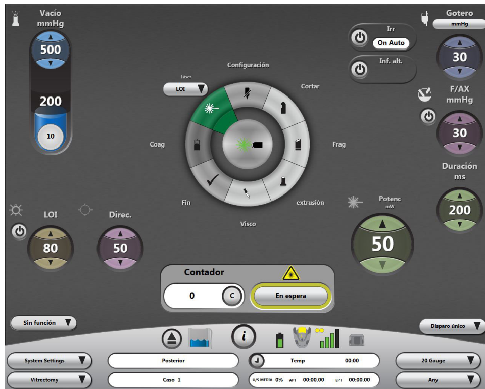
Figura 1.59. Pantalla quirúrgica que muestra el submodo de láser “LIO” seleccionado con el láser en el estado “En espera”. Se visualiza la herramienta de iluminador del LOI indicando que el LOI está conectado.
